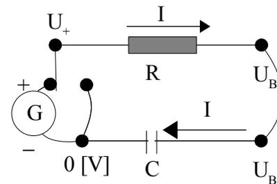
$$\text{Période d'oscillation : } T = T_{\text{décharge}} + T_{\text{charge}} = R \cdot C \cdot \ln\left(\frac{\beta \cdot (1 - \alpha)}{\alpha \cdot (1 - \beta)}\right).$$
