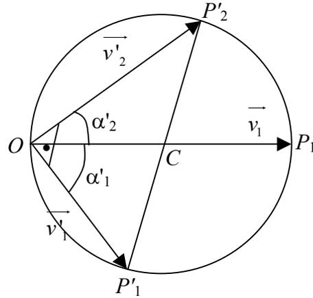
La quantité :  $\frac{\Delta E}{E} = \frac{v_1^2 - v_1'^2 - v_2'^2}{v_1^2}$  représente la perte relative d'énergie cinétique lors du choc. Elle mesure à quel point le choc est élastique. En théorie cette quantité est nulle.
