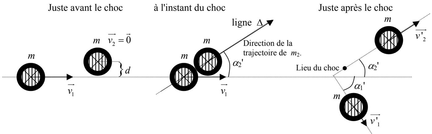
Comme il n'apparaît aucune variation de la quantité de mouvement de l'une ou de l'autre des deux billes dans toute direction perpendiculaire à la ligne  $\Delta$  qui joint les centres des billes "à l'instant du choc", l'angle  $\alpha_2'$  que forme la vitesse  $\vec{v}'_2$  avec la direction de la vitesse  $\vec{v}_1$ , est donné par :
