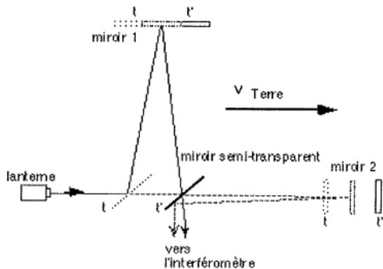
La figure ci-contre, montre le même interféromètre, mais **qui se déplace avec une vitesse  $v_{\text{Terre}}$  par rapport à l'éther**.
