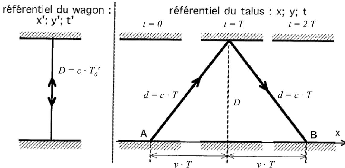
Un observateur situé dans le wagon (**immobile par rapport à l'horloge**), mesurera le temps d'un aller identique au temps de retour  $T_0'$  d'une durée de  $\frac{D}{c}$ . Donc  $D = c \cdot T_0'$ .
