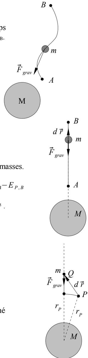
On a donc montré que :  $W_{\vec{F}_{grav}, \text{ de A à B}} = E_{pot, A} - E_{pot, B}$  où  $E_{pot, P} = -G \cdot \frac{m \cdot M}{r_P}$ .
