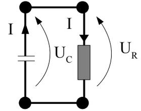
**2. Charge d'un condensateur à travers une résistance.**
