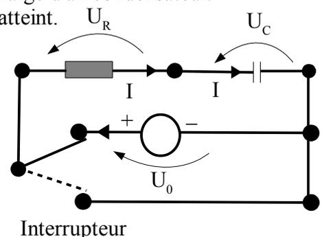
Données :  $R = 15'000 \text{ } [\Omega]$  ;  $C = 10^{-4} \text{ } [F]$  ;  $U_0 = 12 \text{ } [V]$
