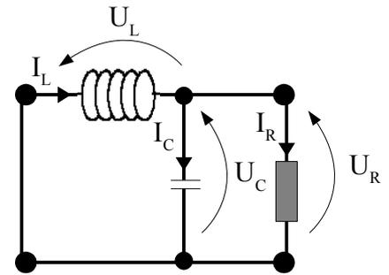
On en déduit un système de deux équations différentielles avec les deux inconnues :  $U_L$  et  $I_C$ .
