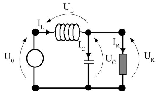
On en déduit un système de deux équations différentielles avec les deux inconnues :  $U_L$  et  $I_C$ .
