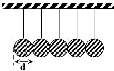
On lâche la première boule qui percute la deuxième. On observe qu'après ce choc, la cinquième boule seule se met en mouvement. Sachant que c'est l'onde qui traverse les 2<sup>e</sup>, 3<sup>e</sup> et 4<sup>e</sup> boules qui met en mouvement la 5<sup>e</sup> boule et que la vitesse du son dans l'acier vaut  $5850 \text{ [m/s]}$ , au bout de combien de temps, après le choc de la première, la cinquième boule se mettra-t-elle en mouvement ?
