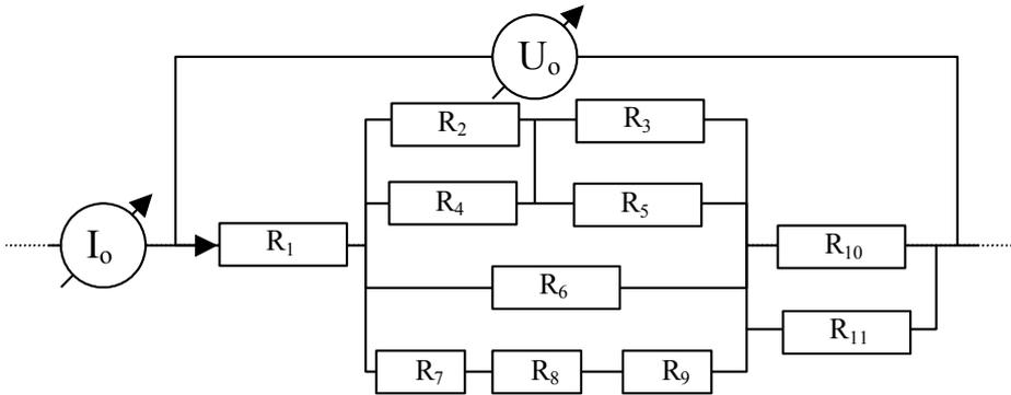
a le même comportement électrique qu'une résistance, dite 'équivalente', qui offrirait la même résistance totale. On peut alors simplifier l'élément de circuit en le remplaçant par cette résistance
