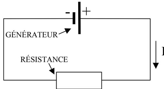
Le courant  $I$  sort de la borne positive du générateur, traverse la résistance (on verra par la suite que c'est à ce moment que l'énergie électrique est consommée), puis rentre dans le générateur par la borne négative.
